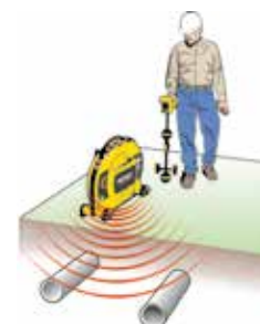
Induzieren eines Signals zur Lokalisierung von Versorgungsleitungen
