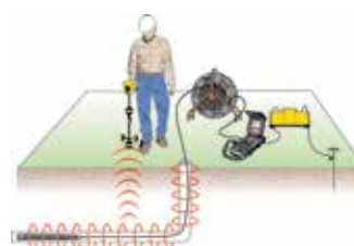
Kunststoffleitungen mit integrierter Leitungssuche aufspüren
